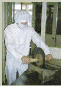
薬研(ヤゲン)で原料を粉末にしている様子
